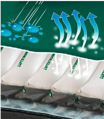
Das grosszellige Wechseldrucksystem besteht aus 17 modular aufgebauten, 130mm hohen Luftzellen aus Polyurethan (PU) und aus einer eingenähten, 50mm hohen Schaummatratze. Im Kopfbereich befinden sich drei statische Zellen. Der Rücken- und Gesässbereich bietet ein angenehmes Mikroklima durch neun laserperforierte Zellen (Luftstromkissen). Durch die vergrösserte Auflagefläche erreicht das SenPro3 eine effektive, optimale Druckentlastung.
